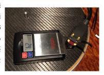
大家有否留意,PurpleHeart的輸出和內阻數據, 0.48mV、42Ω,跟日系高輸出、低內阻唱頭規格相比,明顯有別,反而是一貫的歐洲設計風格,二者音色和音效取向各有不同,各勝擅場。鍾一嘮叨地再要提出,是唱頭的 30mm長度,配合調校精準的超距、循跡null points,安裝到唱臂連唱頭殼的,或獨立universal headshell唱頭殼上,留意(螺絲坑)要比一般的預多一定調整(前後)距離。試音室一直沿用的Ortofon唱頭殼便不合用了,後找來一個日本牌子的,完全靚仔兼合適。
