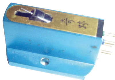
Il primo modello Kiseki Blue, riconoscibile per i fori di montaggio non filettati e l'assenza della fresatura circolare in testa.
